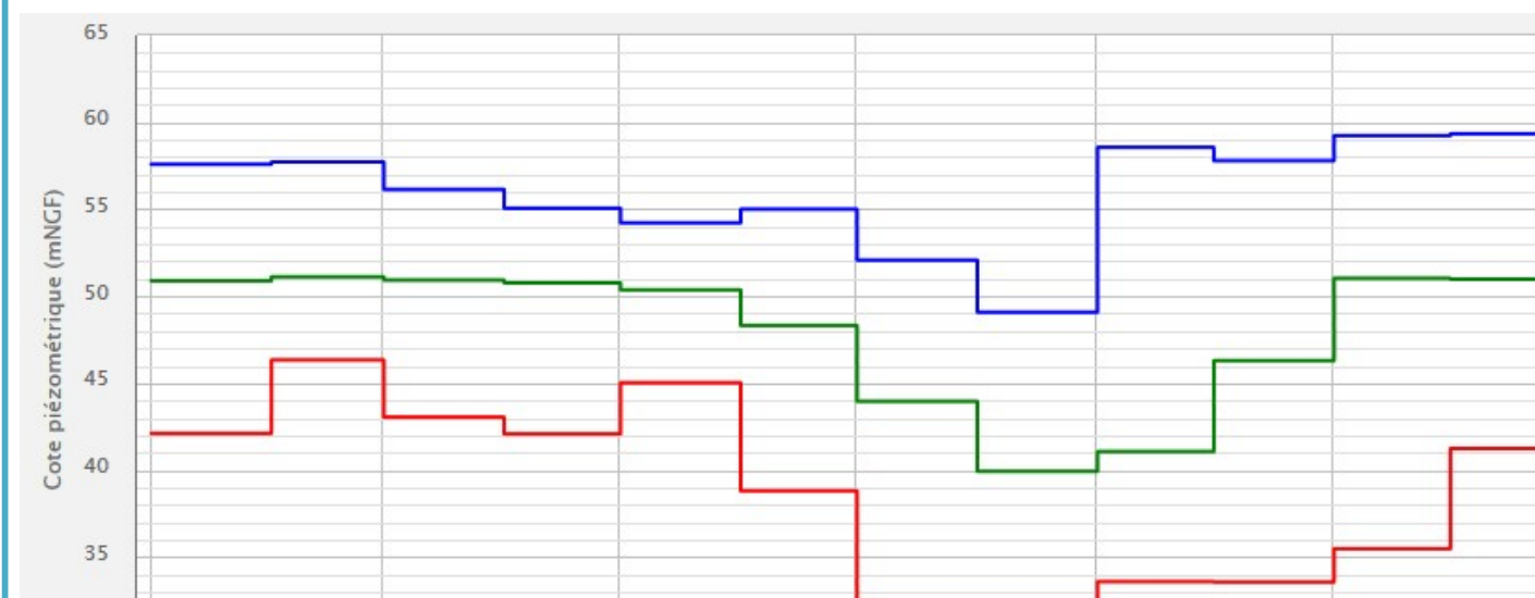
Suivi des niveaux piézométriques du forage BOURDIC 2
