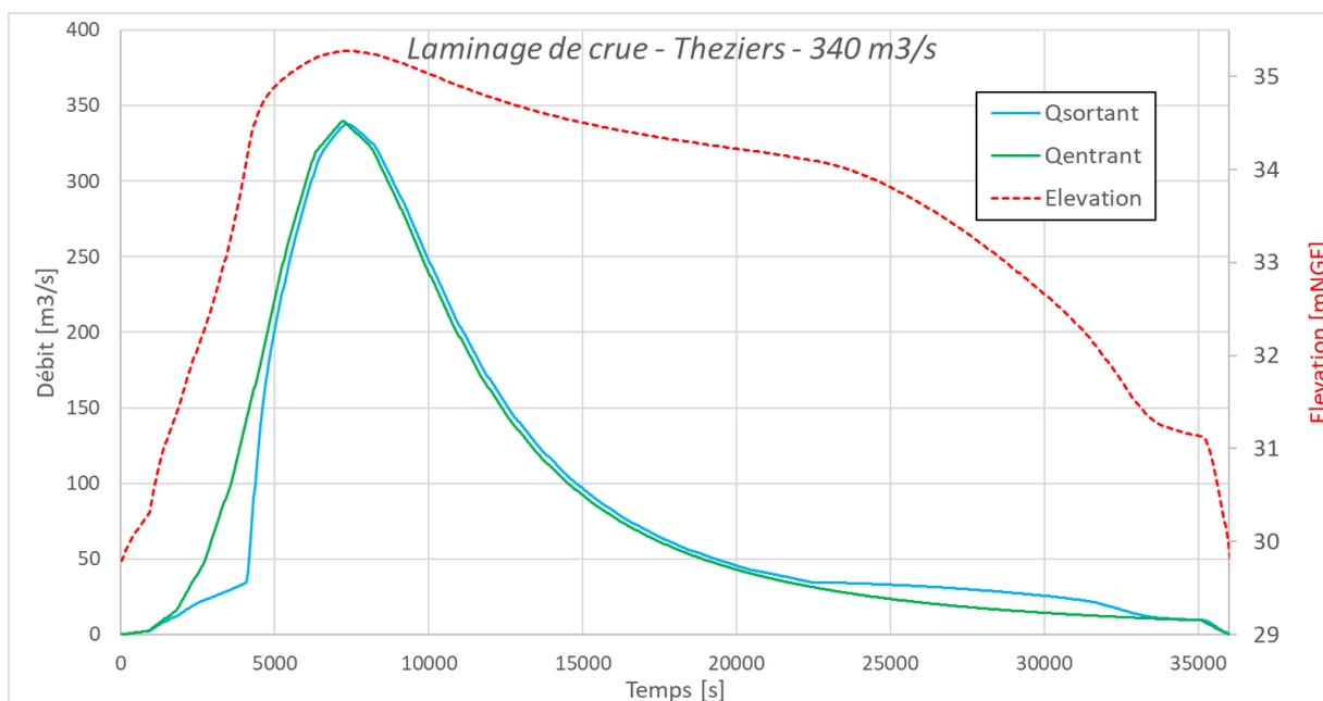
Figure 0-6 : Scénario 2 : laminage de fonctionnement nominal en condition normale pour crue type Q1000
