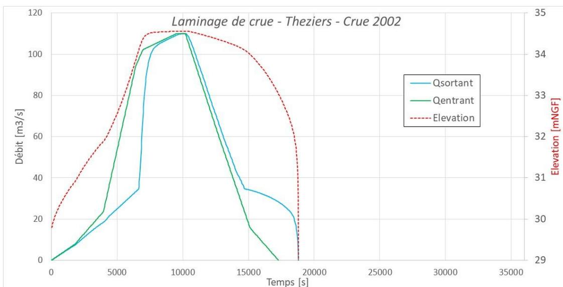
Figure 3-18 : Laminage en condition normale pour crue type 2002
