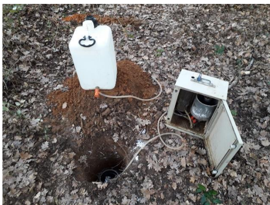
Figure 14 : Photographie du perméamètre à simple anneau utilisé pour réaliser les essais (essai EI03, proche mare LACA10)
