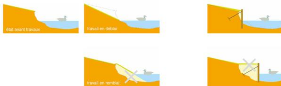
Figure 28 : Schématisation d'une restauration d'une mare, avec intérêt porté sur la pente de celle-ci. Source : Conseil d'Architecture, d'Urbanisme et d'Environnement de l'Eure (CAUE27), 2013.
